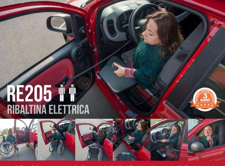
La ribaltina elettrica crea un ponte di collegamento tra il sedile della vettura e la carrozzina, facilitando in questo modo l'entrata e l'uscita dal veicolo. Questo dispositivo è particolarmente adatto gualora ci sia un notevole dislivello
