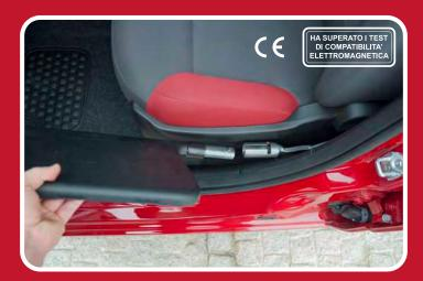
La ribaltina è facilmente rimovibile. Un sistema di sicurezza fermerà automaticamente la salita e la discesa della ribaltina in caso di emergenza. La capacità massima di sollevamento del dispositivo è di 100 kg.
